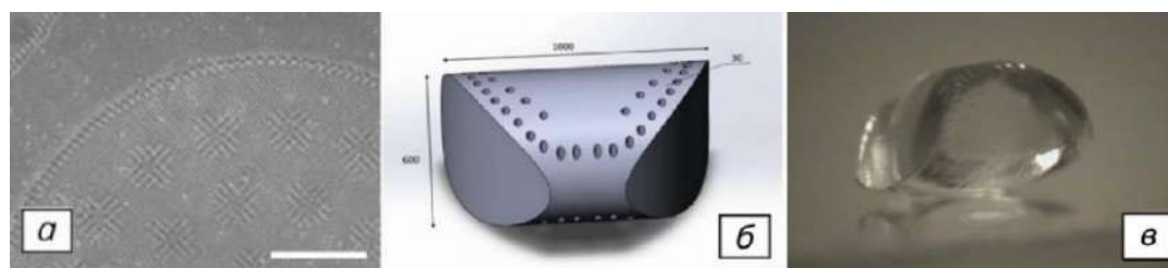
Рис. 29 – (а): Микроструктура на основе CLL (Z-Slice 5, XY-hatch 7); бар 120 мкм. Пример компьютерной модели (б) и микроструктуры (в) из ФПК на основе CLD
