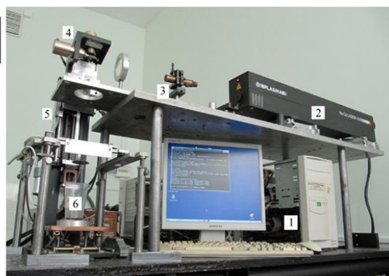
Рисунок Д.2 – Схема и фотография лазерного стереолитографа ЛС120: 1 – управляющий компьютер, 2 – HeCd лазер (длина волны 325 нм), 3 – оптическая система, 4 – сканатор, 5 – устройство вертикального перемещения платформы, 6 – емкость с ФПК
