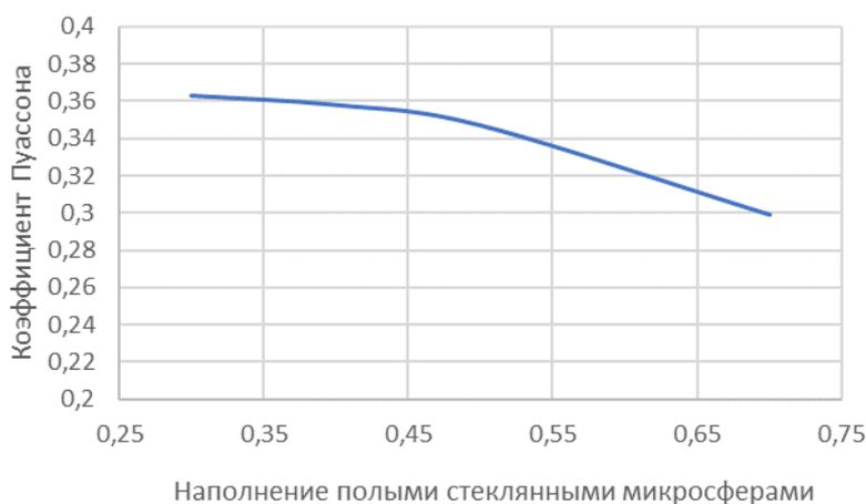
Рис.12 Зависимость коэффициента Пуассона от объемного наполнения композита полыми стеклянными микросферами.
