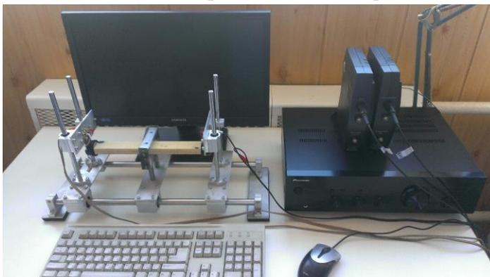
Рис. 13 Внешний вид оборудования для определения динамического модуля упругости синтактовых композитов резонансным методом.
