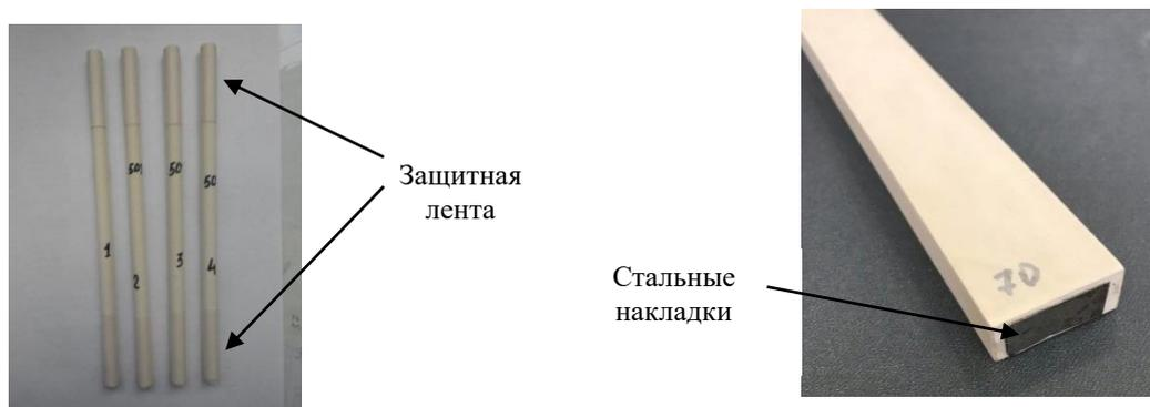
Рис. 7 Образцы синтактового композитного материала: а) для испытаний при статическом растяжении; б) для определения динамического модуля
