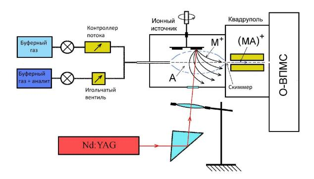
Экспериментальная установка состоит из ионного источника, времяпролетного масс-спектрометра с ортогональным вводом ионов (О-ВПМС), системы подачи газов и Nd:YAG лазера с системой фокусировки лазерного излучения для генерации с поверхности металлической мишени потока катионов металла.
